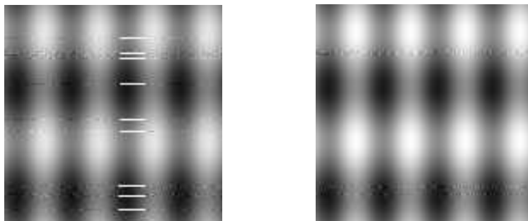
Abb. 14.: Bild mit erkannten (weiß markierten) gestörten Zeilen und korrigiertes Bild
