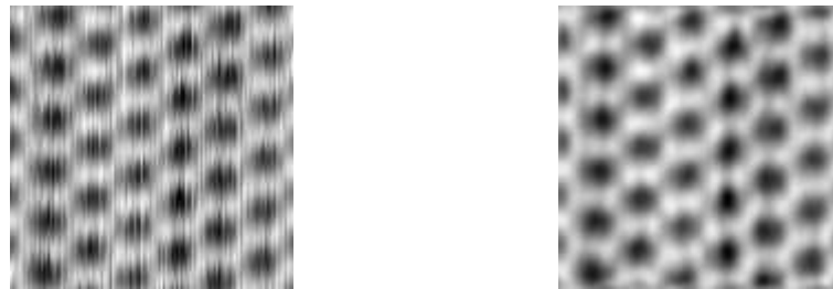
Abb. 15.: Verrauschtes HOPG-Bild, gefiltertes HOPG-Bild
