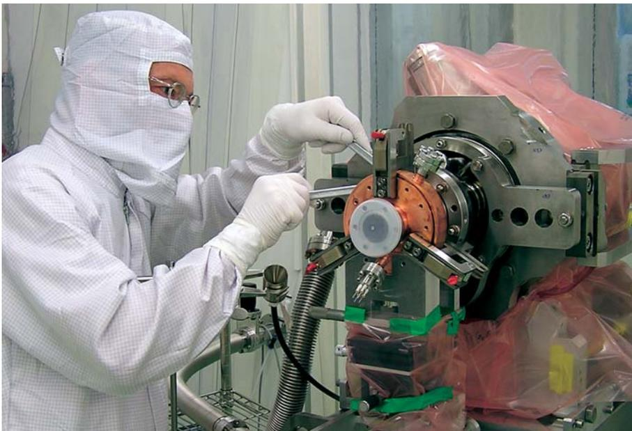
Bei der Montage des Kühlkörpers im August 2007
