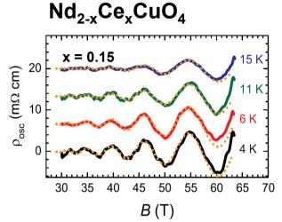
Quantenoszillationsmessungen an Metallen und Supraleitern erlauben einen direkten messtechnischen Zugriff auf deren mikroskopische elektronische Eigenschaften. Aus der Periodizität der Oszillationen des elektrischen Widerstandes (Shubnikov-de Haas-Effekt) und der Magnetisierung (de Haas-van Alphen-Effekt) kann die Fermi-Fläche dieser Materialien bestimmt werden. Die Temperaturabhängigkeit der Oszillationsamplitude erlaubt zudem die Bestimmung effektiver Ladungsträgermassen.
