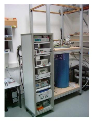
In supraleitenden Quanteninterferometern (SQUIDs) wird die äußerst sensible Magnetfeldabhängigkeit der quantenmechanischen Phasenbeziehung von supraleitenden Ladungsträgern (Cooper-Paaren) in Tunnelkontakten genutzt. In technischer Anwendung können selbst schwächste magnetische Materialeigenschaften mit SQUID-Magnetometern nachgewiesen werden. In Folge werden solche Geräte heutzutage in vielen Wissenschaftsdisziplinen verwendet.
