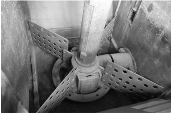
begaster Rührer in einer leeren Flotationszelle (4 m x 4 m x 4 m)
