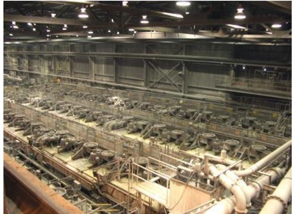
Parallelschaltung von Schaumflotationszellen
