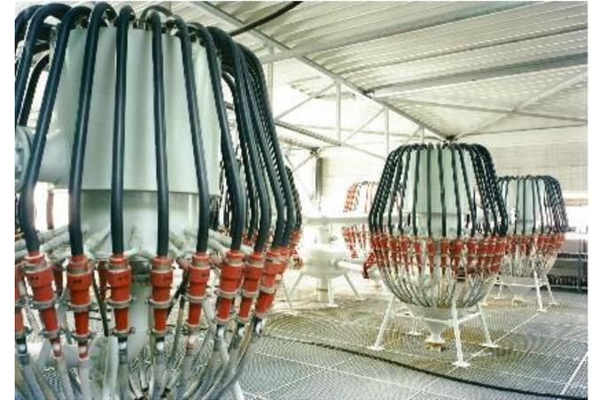
Bild 174. Hydrozyklon
