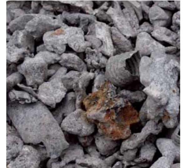
Schlacke und Aschereste thermischer Prozesse als Ausgangsmaterial für die Metallrückgewinnung
