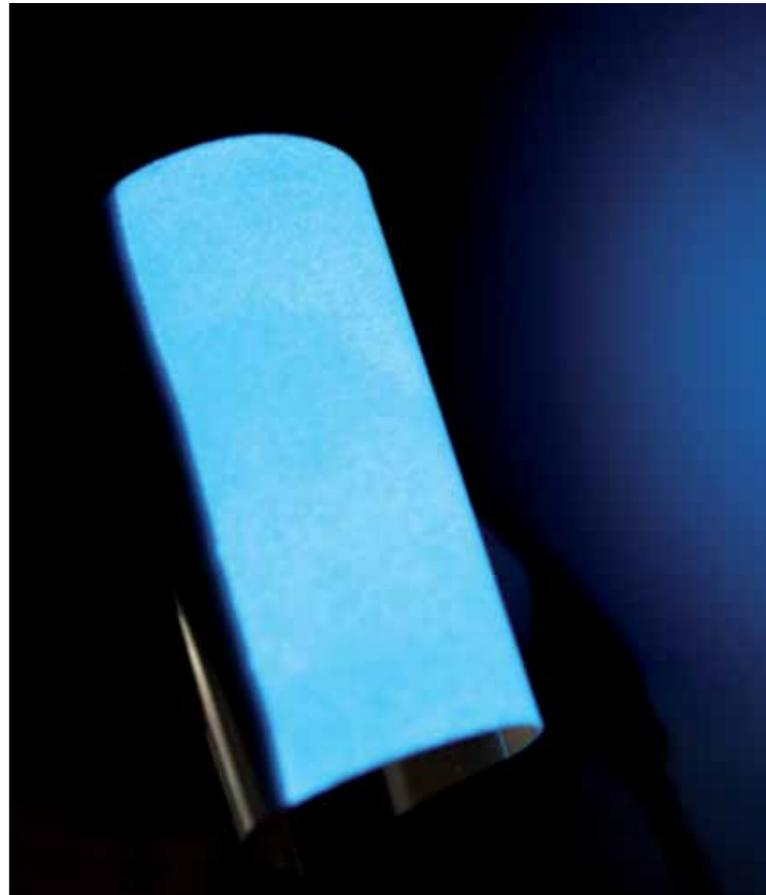
Beschichtungen auf Basis von Fluor-dotiertem Zinndioxid (FTO) sollen den Indium-Zinnoxid (ITO) Einsatz in Dünnschichtbeschichtungen zukünftig überflüssig machen
