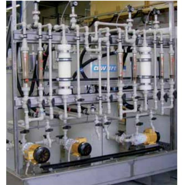
Extraktionsanlage zur Rückgewinnung von Wertmetallen aus Prozesswässern der Phosphatierung
