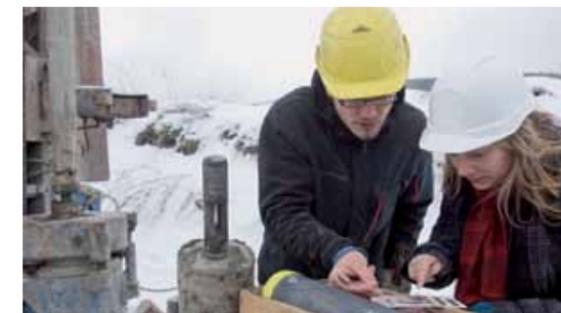
Farbbestimmung des Spülsandes am geöffneten PVC Liner
