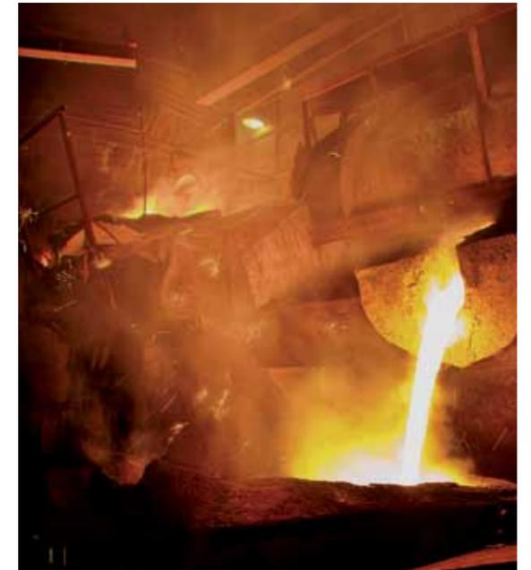
Abstich von Gusseisenschmelzen, für die zur Entschwefelung Magnesium benötigt wird
