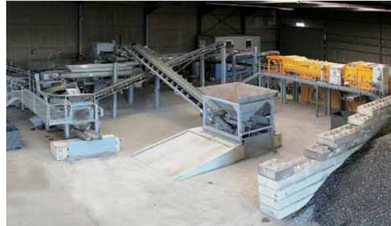
In der VeMRec-Versuchsanlage werden NE-Metalle aus Müllverbrennungsaschen weiter aufbereitet.
