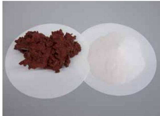
Aus Rotschlamm lassen sich hochwertiges Aluminiumhydroxid, Gallium und Eisen extrahieren
