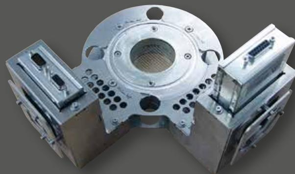
Im HZDR entwickelter Gittersensor für Anwendungen bei hohen Drücken und Temperaturen.
