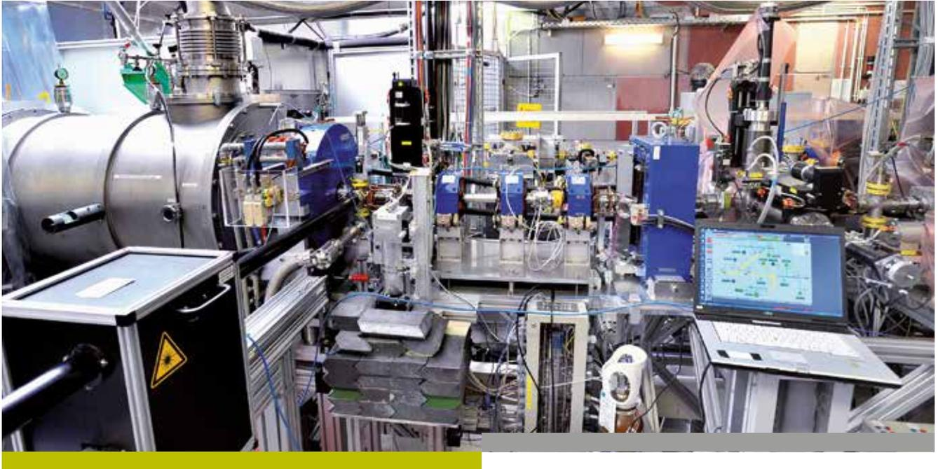
**QUELLE DER STRAHLUNG:** Die für die Untersuchung von Atomkernen nötige Gamma-Strahlung entsteht, wenn die schnellen Elektronen aus dem ELBE-Beschleuniger auf ein spezielles „Target“ treffen. Weil dieses die Elektronen stark abbremst, sprechen die Physiker hier auch von Bremsstrahlung. Foto: Frank Bierstedt
