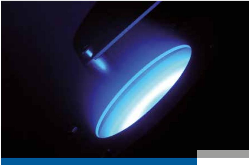
**TITAN:** Je mehr Titanatome ionisiert werden, desto blauer sieht das Plasma in der Beschichtungskammer aus. Foto: Jürgen Jeibmann
