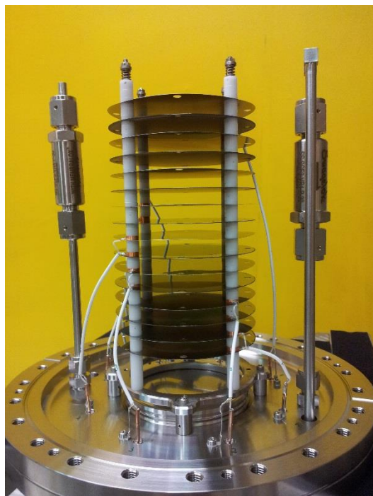
^{242}\text{Pu} deposit 74 mm diam. Areal density \approx 125 \mu\text{g}/\text{cm}^2 Institut für Kernchemie, Mainz
