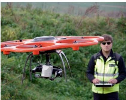
Die Zukunft der Rohstofferkundung: Robert Zimmermann steuert eine Aibot-Drohne, an die eine Hyperspektralkamera gekoppelt ist.
