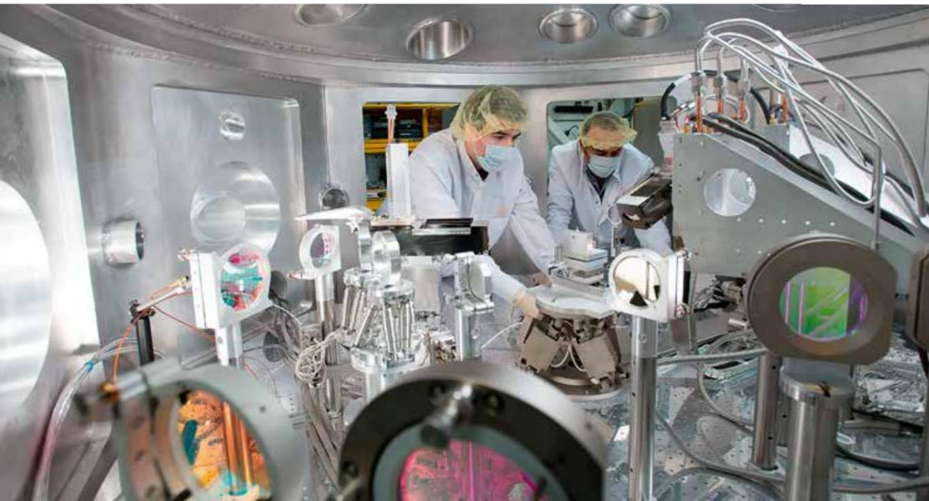
Das MEC-Instrument (Matter in Extreme Conditions) am Stanford Linear Accelerator Center (SLAC) kombiniert optische Laser mit Freie-Elektronen-Röntgenlasern. Solche Möglichkeiten gibt es ...
