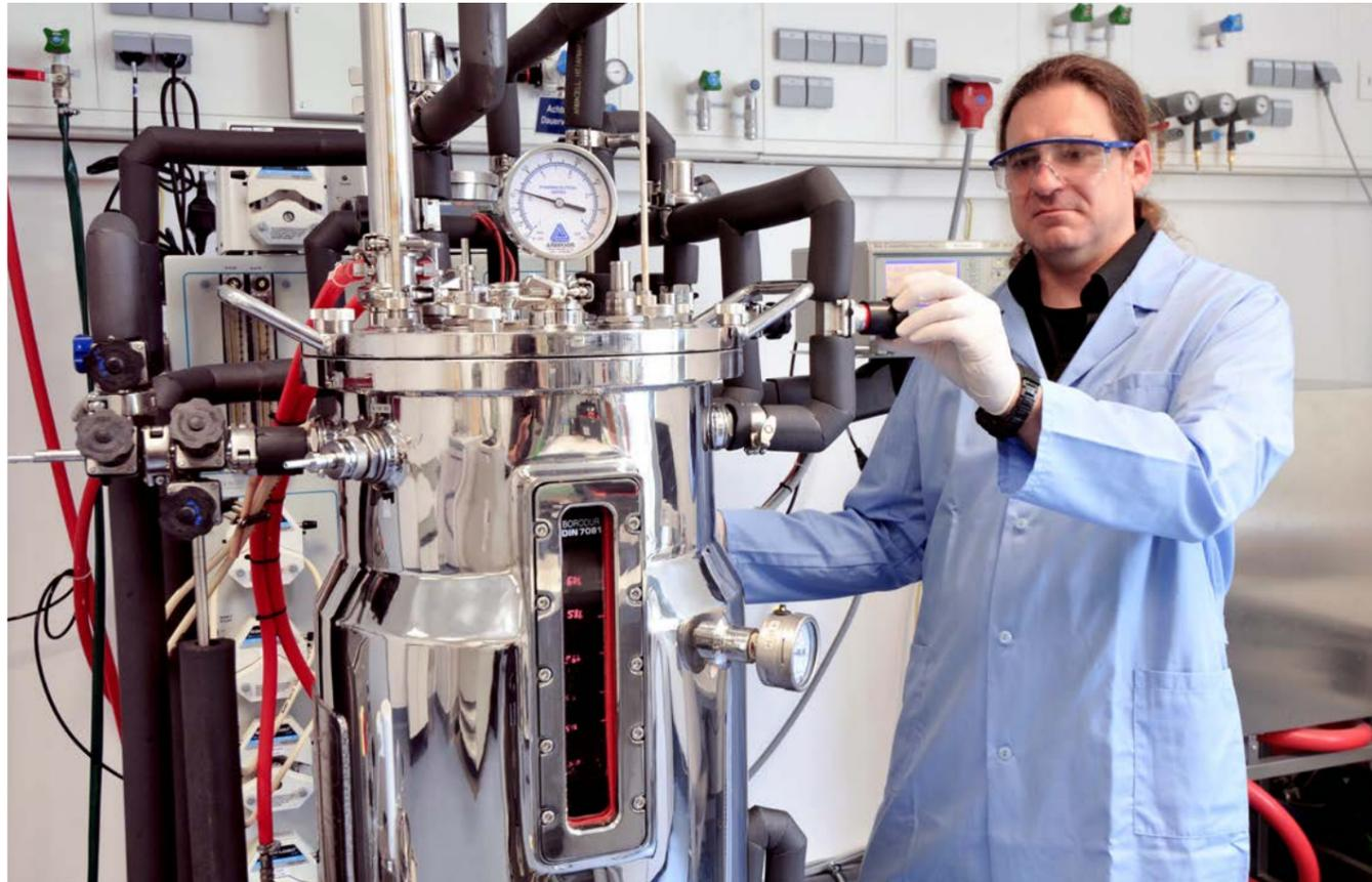
Um Metalle zu gewinnen, greifen die Forscher\*innen auf Mikroorganismen zurück. Damit Letztere wachsen und arbeiten können, müssen sie jedoch optimale Bedingungen vorfinden. Eine solche Wohlfühlzone bieten Bioreaktoren. Sie regeln die Sauerstoffzufuhr, die Temperatur oder den pH-Wert und gewährleisten so die Nährstoffversorgung der Mikroorganismen.
