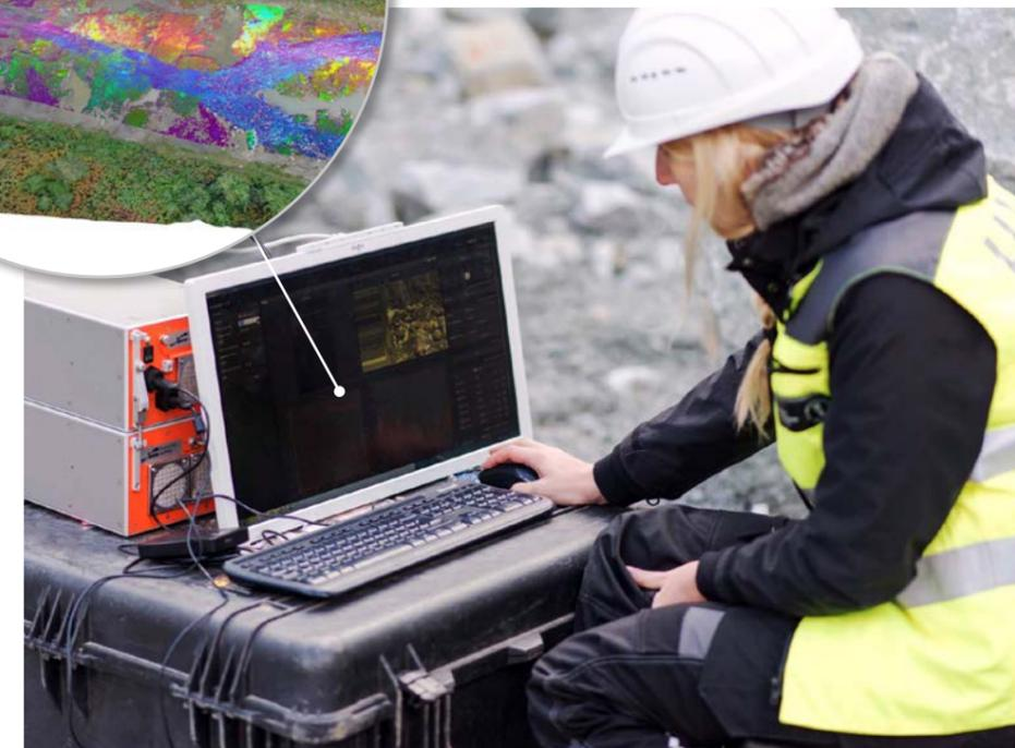
Noch im Gelände können mittels der gesammelten Daten der Hyperspektralkameras Modelle des untersuchten Geländes erstellt werden. Die verschiedenen Farben geben Auskunft über unterschiedliche Mineralgehalte.
