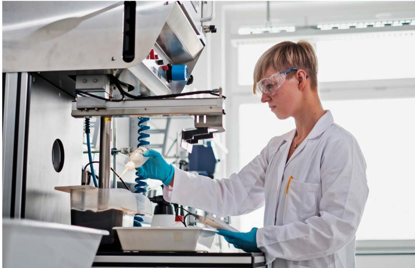
Um die Trennprozesse auf der Mikroebene zu verstehen, experimentieren HIF-Forscher\*innen mit Flotationszellen sowohl im Labor- als auch im Pilotmaßstab.
