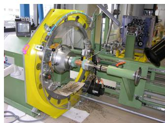
Wickelmaschine mit Spule
