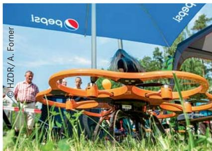
So gut ist sie selten zu sehen: Denn normalerweise schwebt die Aibot-Drohne des Helmholtz-Instituts Freiberg für Ressourcentechnologie (HIF) mehrere Meter über dem Boden. Solch unbemannte Luftfahrtsysteme könnten eine sanfte Erkundung von Rohstoffen ermöglichen. Ohne aufwendige Bohrungen, die massiv in die Landschaft eingreifen, liefert der Hexakopter erste Hinweise auf mögliche Vorkommen unter der Erde. Am Tag des offenen Labors lenkte die Drohne auf jeden Fall schon viele Blicke in den Himmel.
