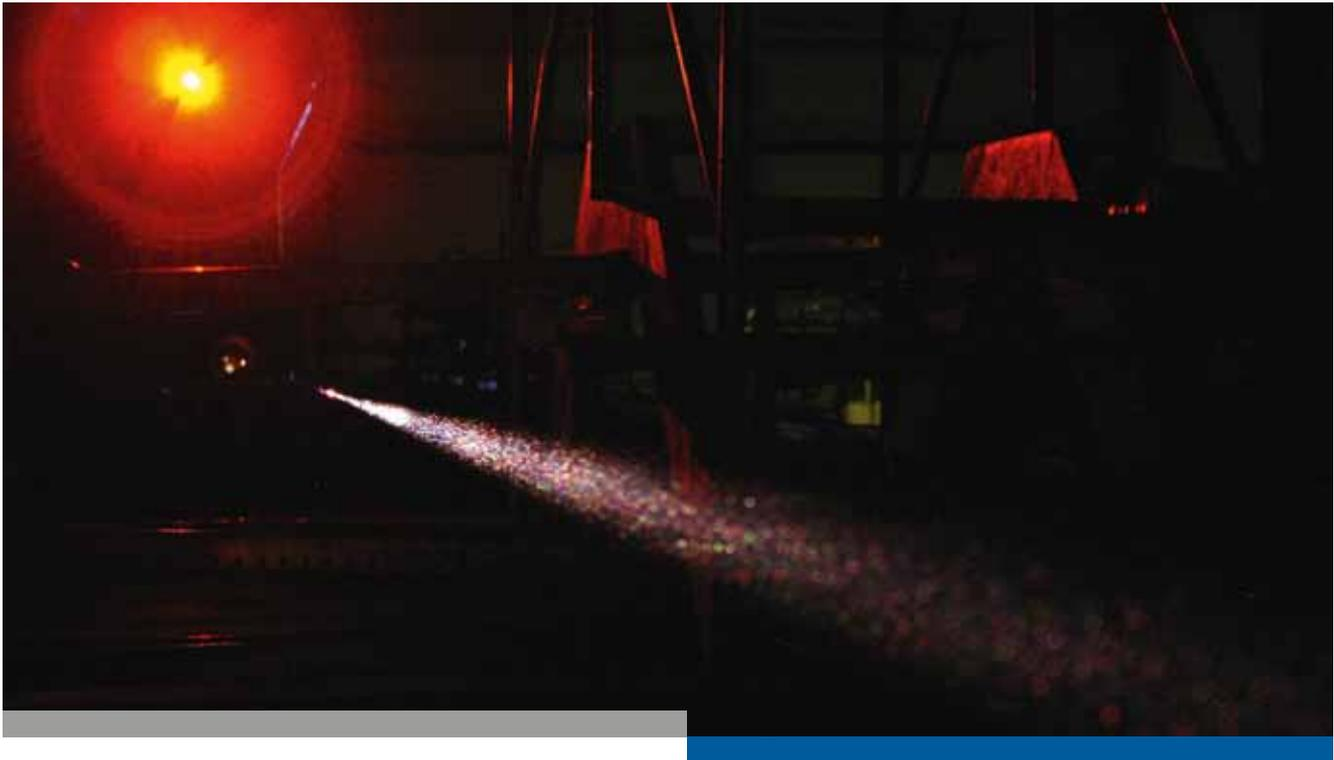
**LICHTFEUERWERK:** Fokussiert man den Strahl eines Hochleistungslasers in Luft, so bildet sich ein Filament – ein Bereich, in dem Laserlicht und Materie so wechselwirken, dass ein neues Lichtspektrum entsteht. Hier erzeugt weißes Licht, das im weiteren Verlauf auf Staub in der Luft trifft, buntes Laserlicht.
