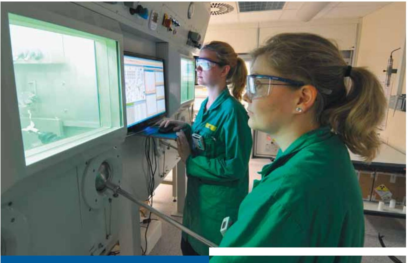
**INTERNE BESTRAHLUNG:** Silke Fähnemann (rechts) und Manja Kubeil arbeiten vor zehn Zentimeter dicken Bleiglasscheiben an radioaktiven Substanzen, mit denen man in Zukunft Krebszellen „von innen“ bestrahlen kann. Foto: Frank Bierstedt
