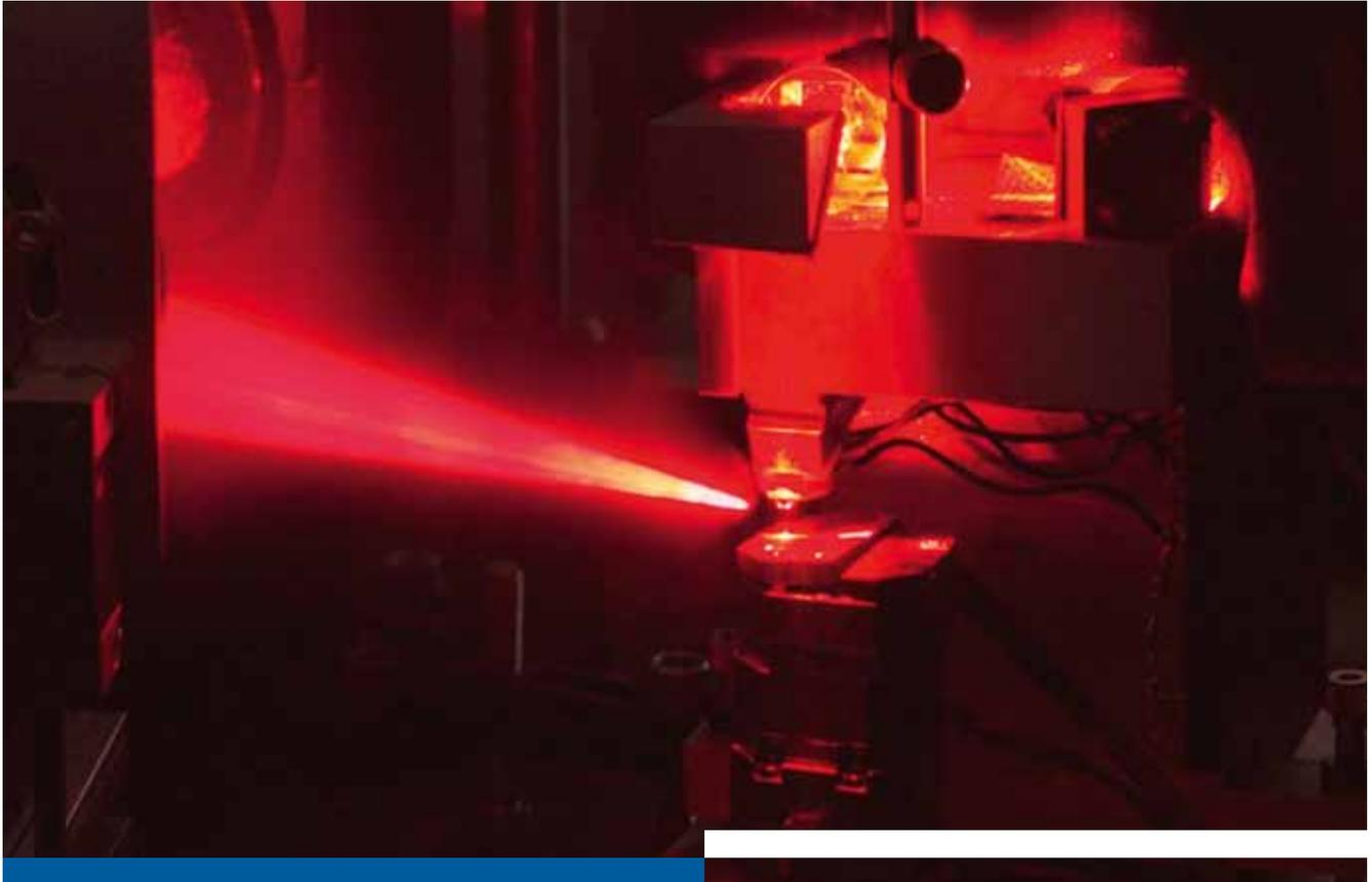
**AUS NÄCHSTER NÄHE:** In der Nahfeld-Mikroskopie wird ein Justierlaser eingesetzt, um die hauchdünne Messspitze des Mikroskops richtig zu positionieren. In der Verlängerung des Laserstrahls kommt von oben die Spitze, darunter befindet sich die Einheit zur Bewegung der Probe. Foto: Hans-Georg von Ribbeck
