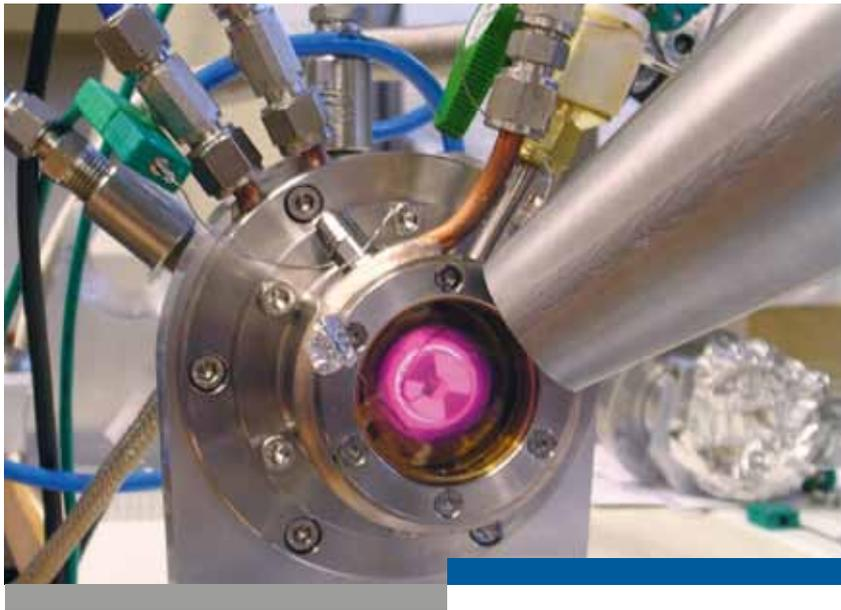
**FORSCHUNG IN ECHTZEIT:** Röntgenstrahlen erlauben, chemische Reaktionen unter extremen Bedingungen zu untersuchen. Hier wird eine Probe in einer katalytischen Zelle unter in situ-Bedingungen erhitzt. Ein großer Automobilhersteller hat diese Technik an der ESRF eingesetzt, um die Lebensdauer von Katalysatoren zu verbessern. Foto: ESRF/B. Gorges
