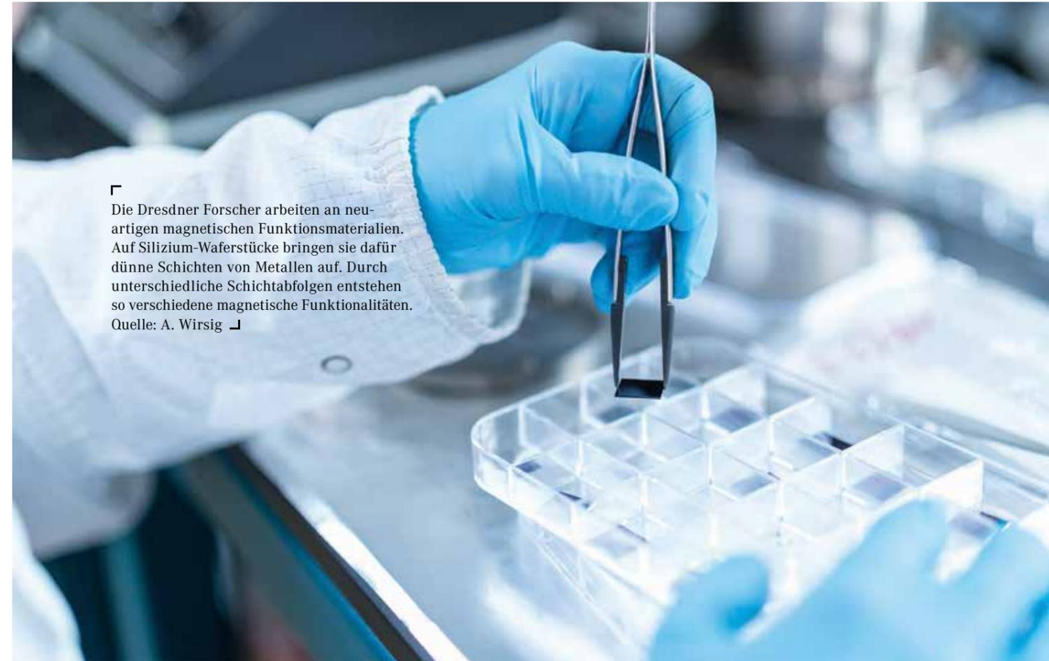
Die Dresdner Forscher arbeiten an neuartigen magnetischen Funktionsmaterialien. Auf Silizium-Waferstücke bringen sie dafür dünne Schichten von Metallen auf. Durch unterschiedliche Schichtabfolgen entstehen so verschiedene magnetische Funktionalitäten. Quelle: A. Wirsig
