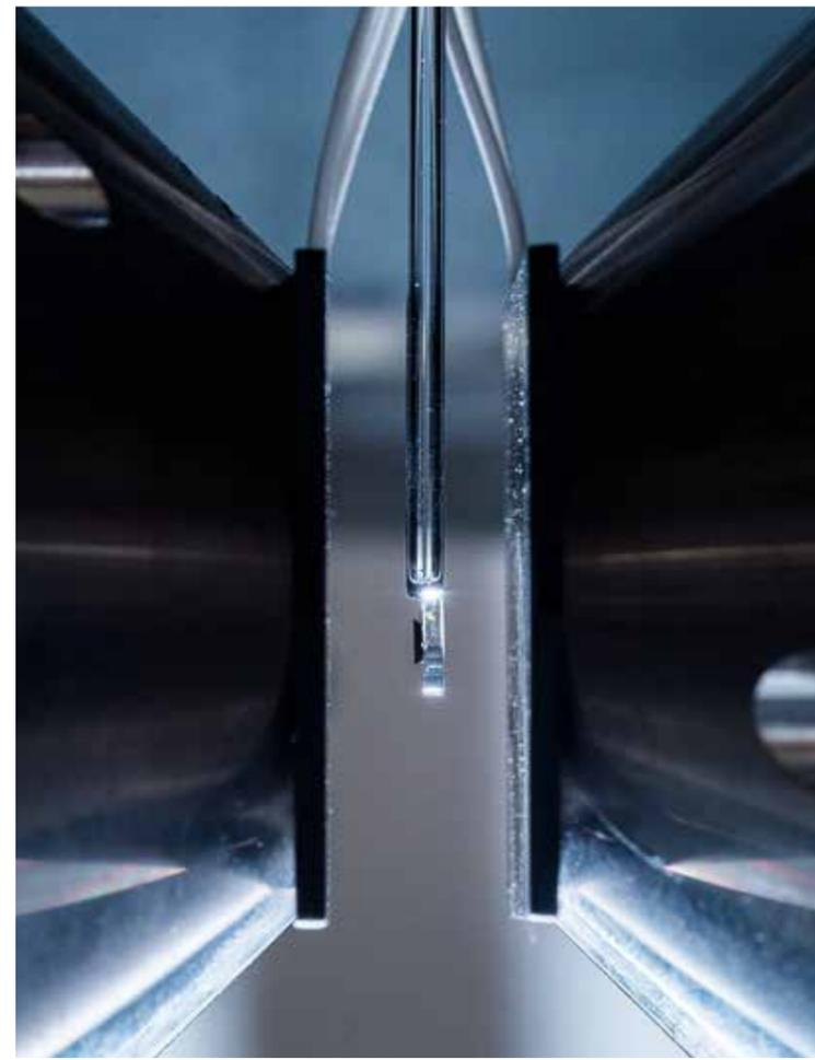
Am Magnetometer können die Forscher das magnetische Schaltverhalten der beschichteten Silizium-Waferstücke genau analysieren. Quelle: A. Wirsig
