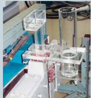
Bild 2: Plexiglasmodell für Laborexperimente installiert an einem DC-Magnetsystem
