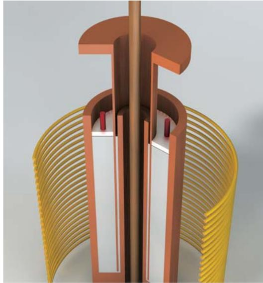
Fig. 2: Bild des PROMISE-Experiments. Durch Ströme in der großen gelben Spule wird das axiale Magnetfeld erzeugt. In der Mitte ist das axiale Kupferrohr zu erkennen, in dem Ströme bis 8000 A zur Erzeugung des Azimutalfeldes fließen.
