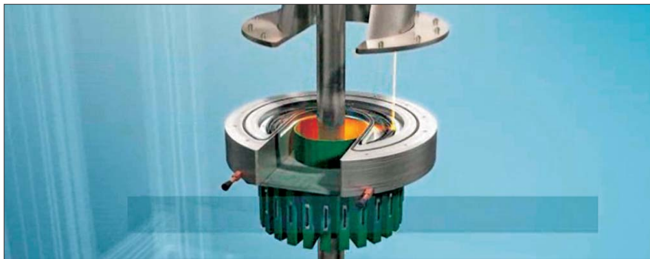
Am Institut für Fluidodynamik wird Messtechnik zur Untersuchung von flüssigen Metall- sowie von komplexen Mehrphasenströmungen (im Bild der Elektronenstrahl-Tomograph ROFEX) entwickelt.
