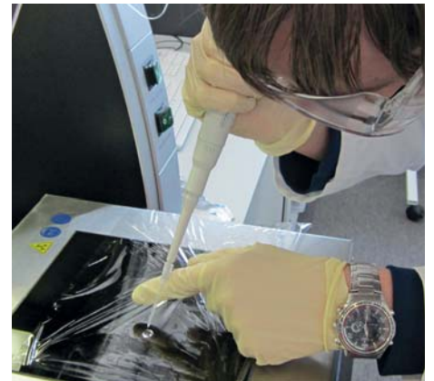
Auf dem UV-Tisch wird eine DNA-Probe aufgetragen, um sie anschließend zu bestrahlen.
