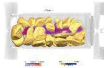
PET/CT-Aufnahme eines Durchfluss-Experiments mit einem radioaktiven Tracer
