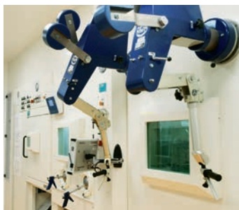
Arbeitsplätze zur Handhabung radioaktiver Stoffe mit einer umlaufenden Abschirmung aus 10 cm dickem Blei, ausgestattet mit Manipulatoren und automatischen Systemen
