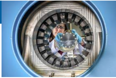
Gesteinsbohrkern im Detektorfeld eines Positronen-Emissions-Tomographen
