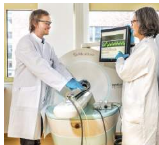
Nutzung einer kombinierten Kleintier-Kamera zur Darstellung biochemischer Prozesse mittels PET sowie zur funktionell-anatomischen Bildgebung mit MRT in Nagern
