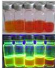
Radiomarkierte und fluoreszierende [ 76 Se]CdSe Quantum Dots (≤ 3 nm) als partikuläre Tracer für die Nano-Sicherheitsforschung
