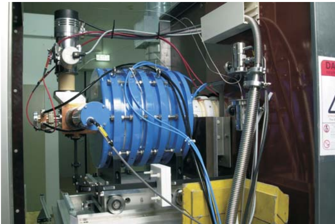
Abbildung 2: ECR-Ionenquelle im Institut für Ionenstrahlphysik und Materialforschung des FZ Rossendorf
