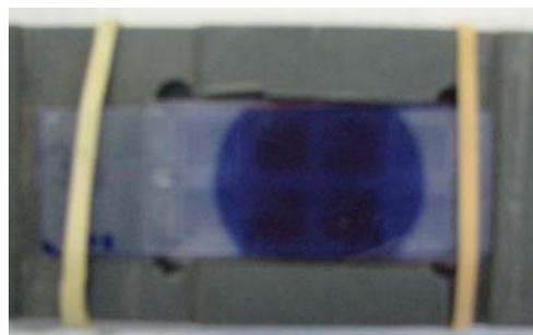
*Prinzip der Elektronenbeschleunigung durch Fokussierung des intensiven Laserstrahls auf einen Gasstrahl (links) und der mit einem Filmdosimeter sichtbar gemachte Elektronenstrahlfleck auf den die Zellen enthaltenden vier Kammern eines Probensträgers (rechts)*
