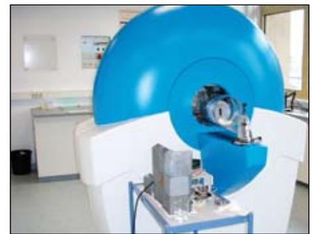
**PET-Kamera ClearPET der Forschungsstelle Leipzig während der Untersuchung von Transportvorgängen in einem Salzgesteinsbohrkern**
