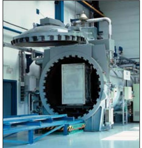
An der TOPFLOW-Anlage im FZD können die Strömungsverhältnisse in den Kühlkreisläufen von Kernkraftwerken untersucht werden.
