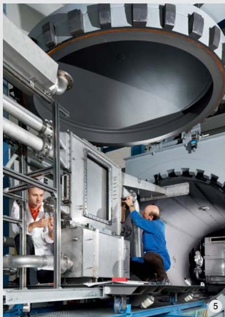
Im Jahr 2005 wird die Versuchsanlage TOPFLOW um einen **Drucktank** erweitert, der Experimente bis zu einem Betriebsdruck von fünf Megapascal im Druckgleichgewicht ermöglicht. Dadurch lassen sich Strömungen unter Industriebedingungen z.B. direkt mit einer Kamera beobachten. (5)
