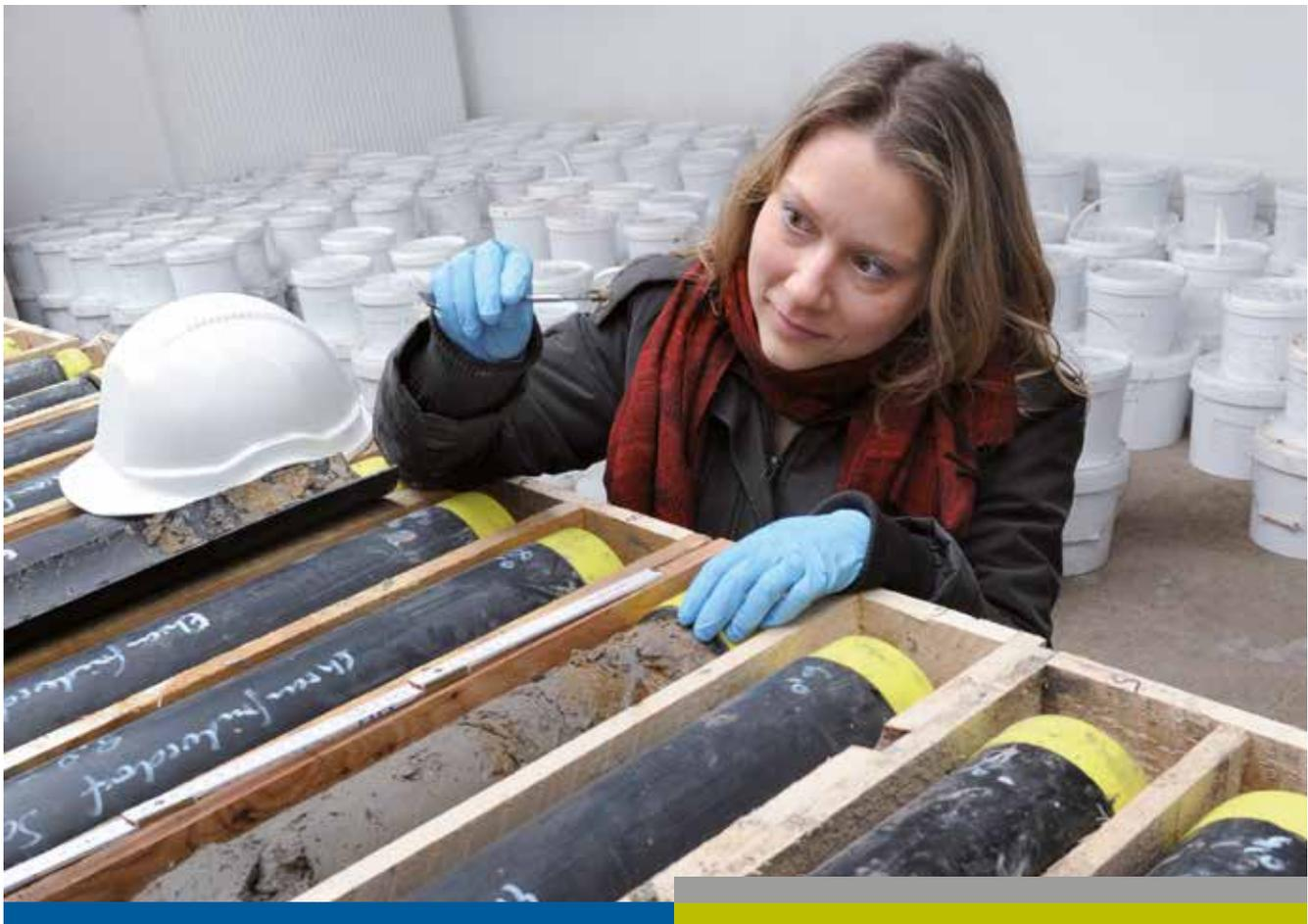
**FORSCHUNGSARBEIT:** Bevor die Geologin Inga Osbahr das in PVC-Rohren verpackte Haldenmaterial unter einem Elektronenstrahl auf seine Bestandteile hin untersuchen kann, muss das sandige Gemisch noch aufbereitet werden. Foto: VNG – Detlef Müller
