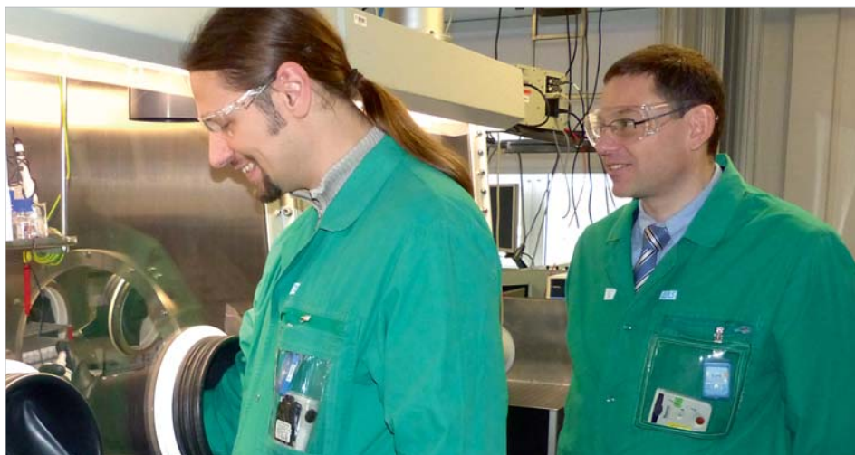
An einer Handschuhbox für radioaktive Substanzen bereiten Moritz Schmidt (links) und Thorsten Stumpf eine Probe vor, um ihre Fluoreszenz mit spektroskopischen Methoden zu untersuchen. Anhand der Spektren und Leuchtdauer können die beiden Radiochemiker feststellen, ob der radioaktive Stoff eine feste Verbindung mit Mineralen eingeht.
