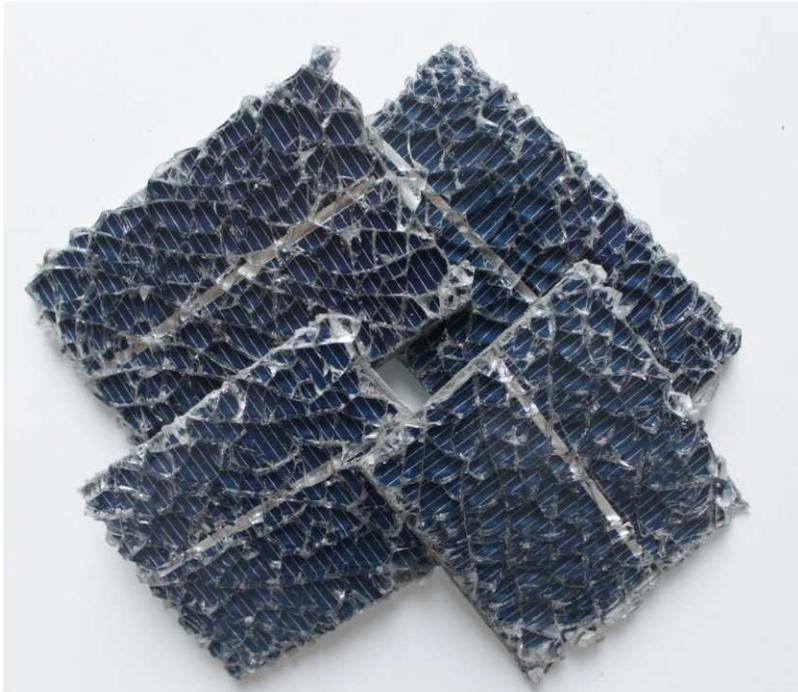
Bild: polykristallines Siliziummodul vor der Schockwellenbehandlung
