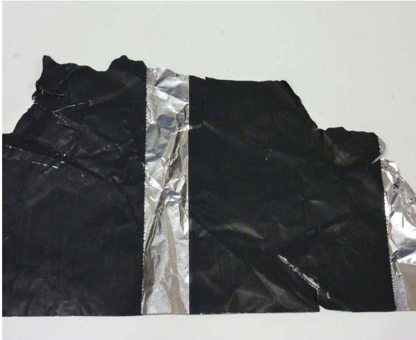
Bild: Kathodenmaterial aus der Batteriezellenfertigung
