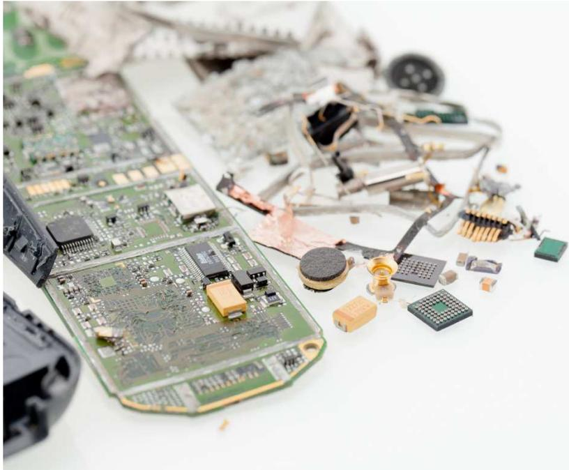
Bild: Leiterplatte eines Handys nach der Schockwellenbehandlung
