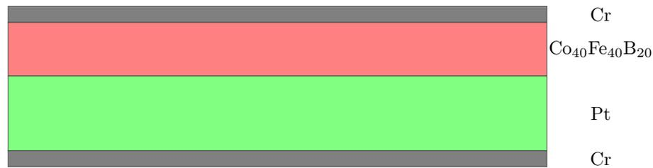
**Abbildung 3.5:** Die verschiedenen Schichten der Probe. Die beiden mittleren Schichten, Pt (grün) und  $\text{Co}_{40}\text{Fe}_{40}\text{B}_{20}$  (rot) dienen der Erzeugung von Autooszillationen. Die untere Chromschicht dient als Haftschicht des Platins auf dem Siliziumsubstrat (nicht im Bild eingezeichnet), die obere als Oxidationsschutz.
