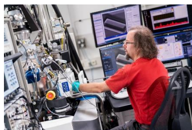
Ionenstrahlanalytik im Nanometer-Bereich ist mit dem Helium-Ionen-Mikroskop möglich. Foto: HZDR/ A.Wirsig
