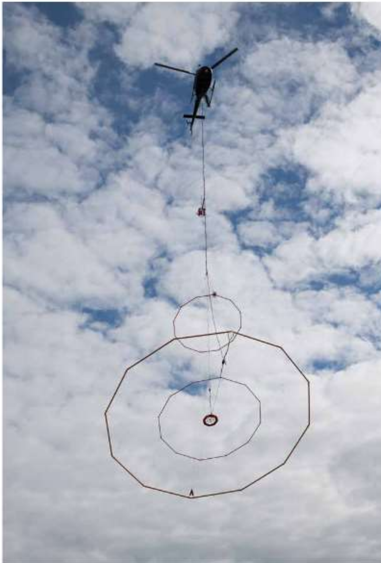
Abb. 1: Datenerfassung der Hubschrauber-Elektromagnetik als Referenztechnik
