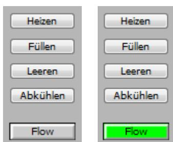
Bleibt das Flowmeter innerhalb von 20s 2mal stehen fährt es automatisch runter.
