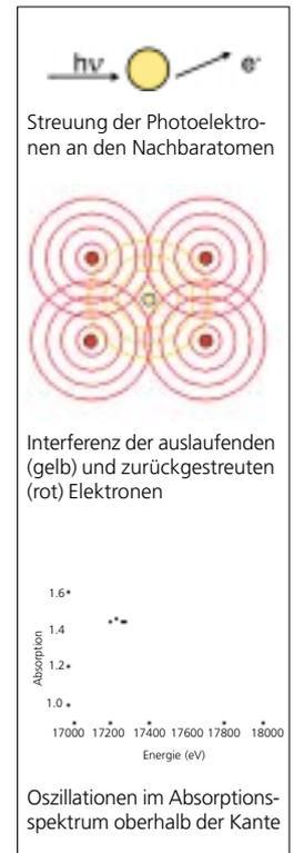
**Abb. 6** Uran L3-Kante XAS-Spektrum und schematische Darstellung des Ursprungs der EXAFS-Oszillationen.
